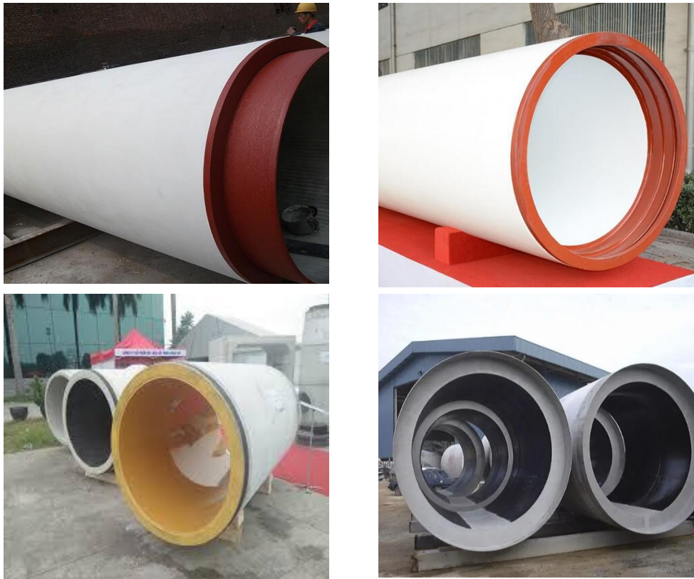
Hình 1. 14: Hình ảnh hoàn thiện, sơn phủ lòng cống
