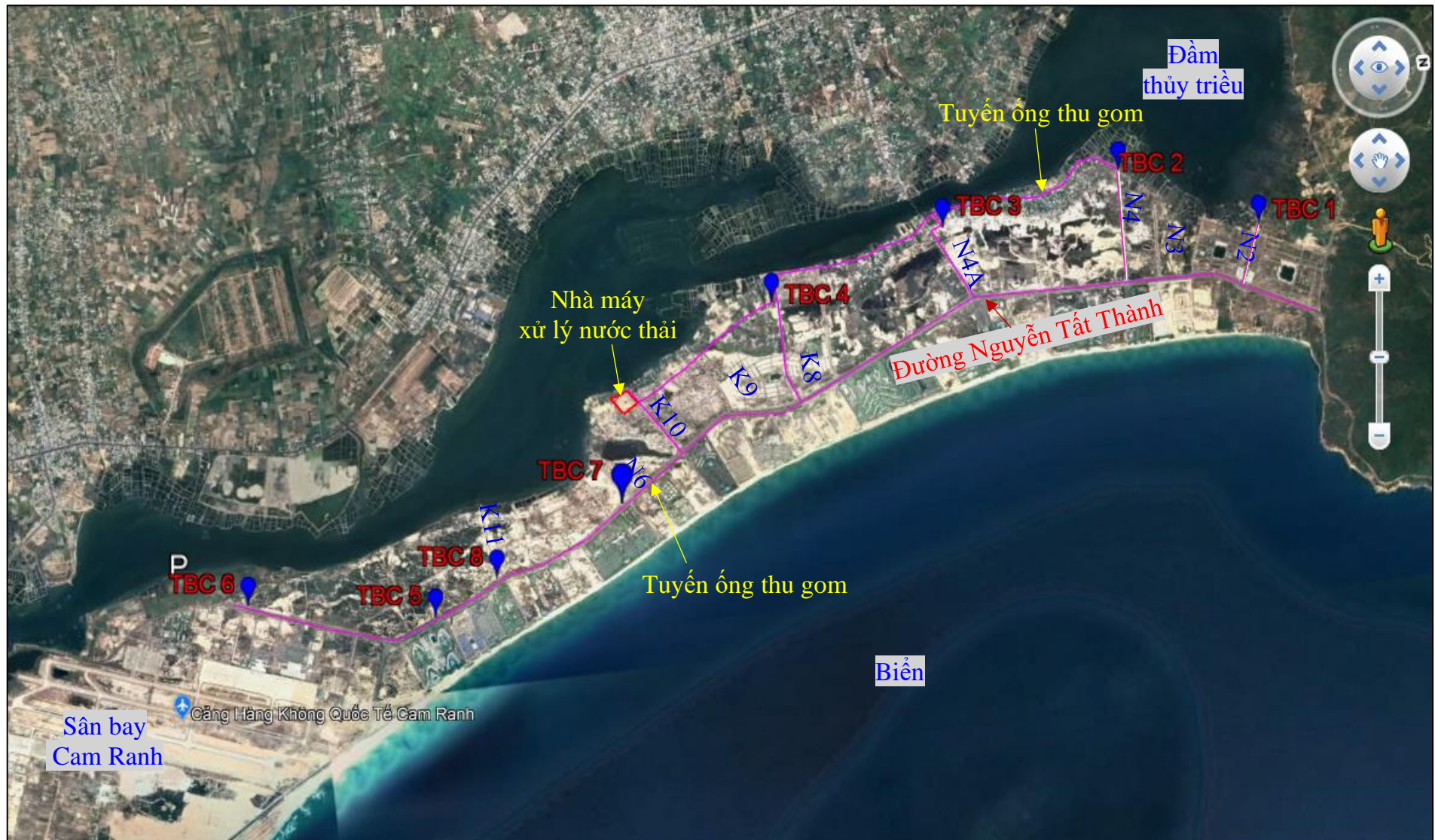
Hình 1.1. Vị trí tuyến công thu gom, các trạm bơm chính và nhà máy XLNT trên nền bản đồ vệ tinh Google Map
