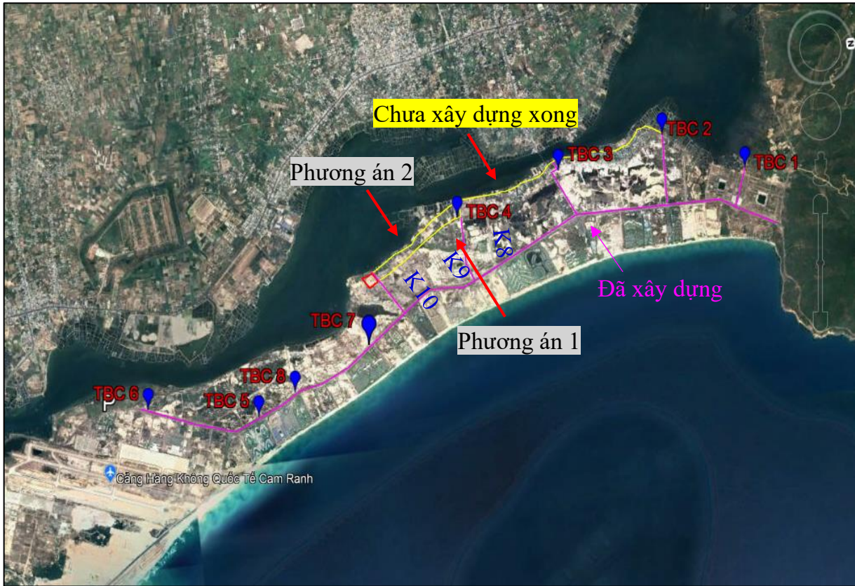
Hình 1.8. Hiện trạng xây dựng tuyến ống thu gom, trạm bơm
