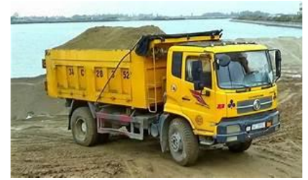
Ô tô 10T vận chuyển vật liệu nạo vét từ bến nhô vào bãi thải
