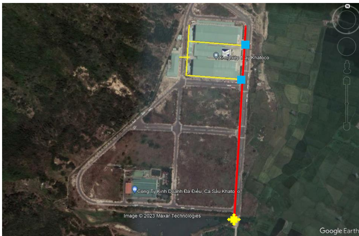
Hình 3. 1 Sơ đồ hướng thoát nước mưa của Nhà xưởng xí nghiệp may
