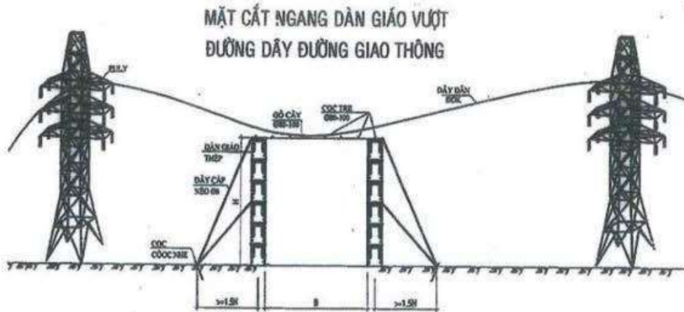
Hình 3-3: Sơ đồ minh họa giàn giáo đỡ dây dẫn thi công vượt đường giao thông
