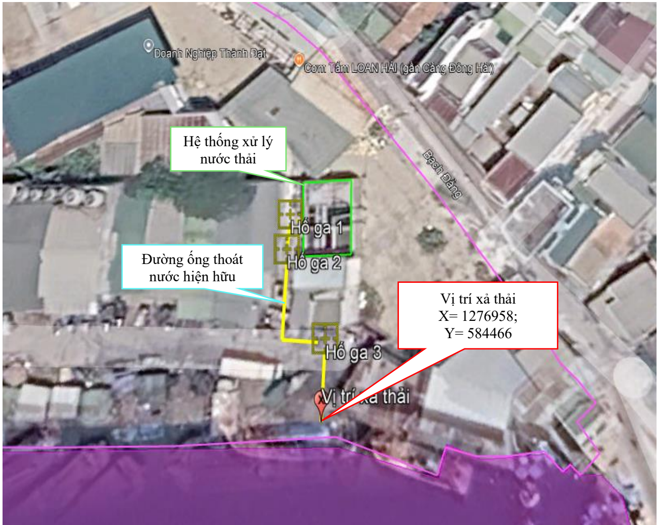
Hình 3.4: Sơ đồ thoát nước thải của khu vực Cảng cá
