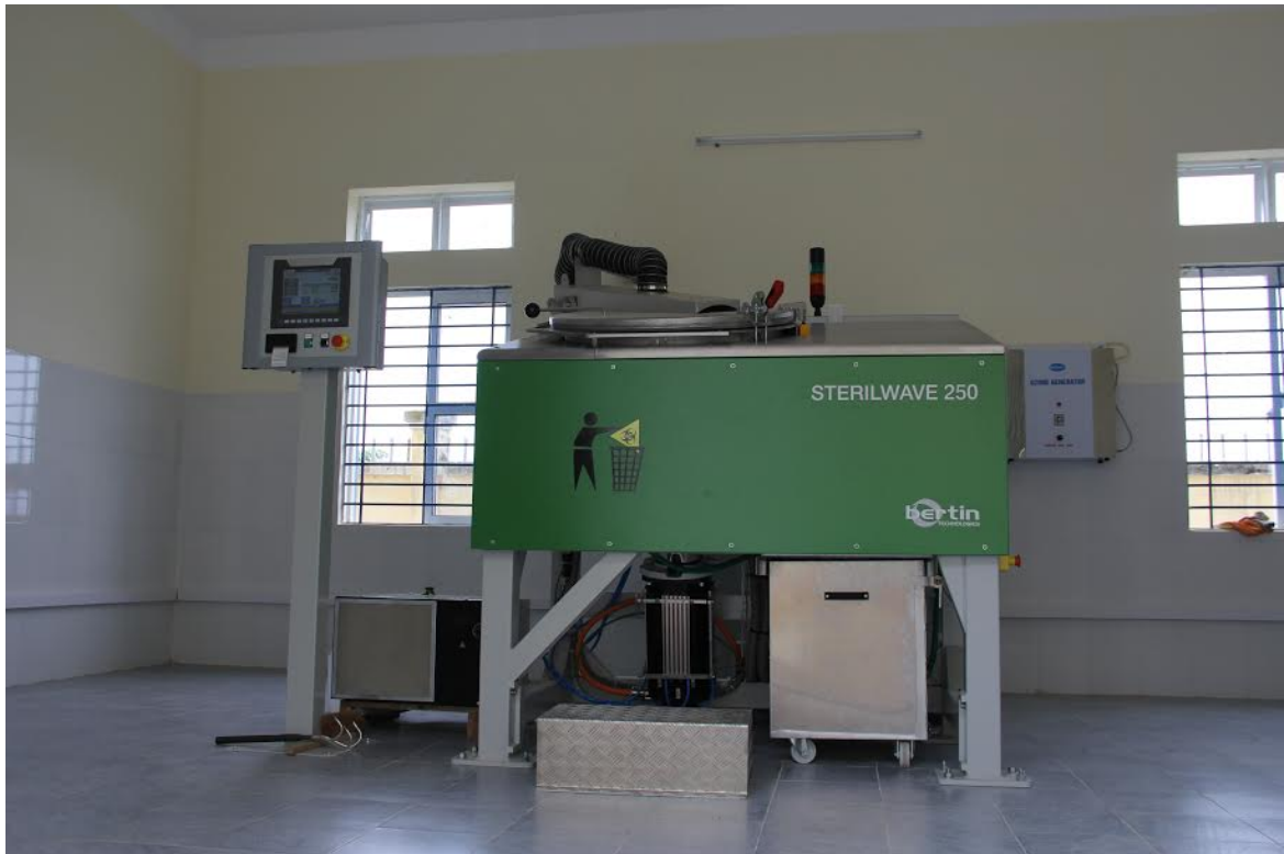
Hình 3.6. Thiết bị xử lý chất thải rắn y tế lây nhiễm bằng công nghệ vi sóng tích hợp nghiền cắt trong cùng khoang xử lý
