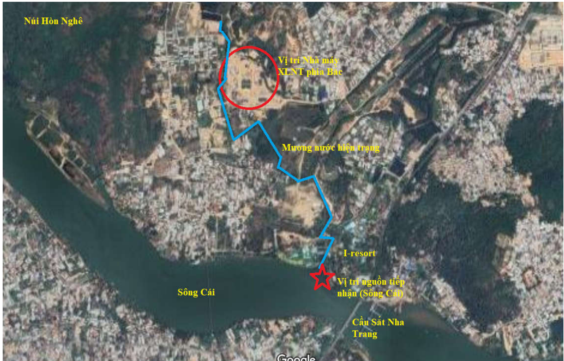
Hình 2. Mặt bằng thoát nước thải sau xử lý vào mương thoát đưa về sông Cái
